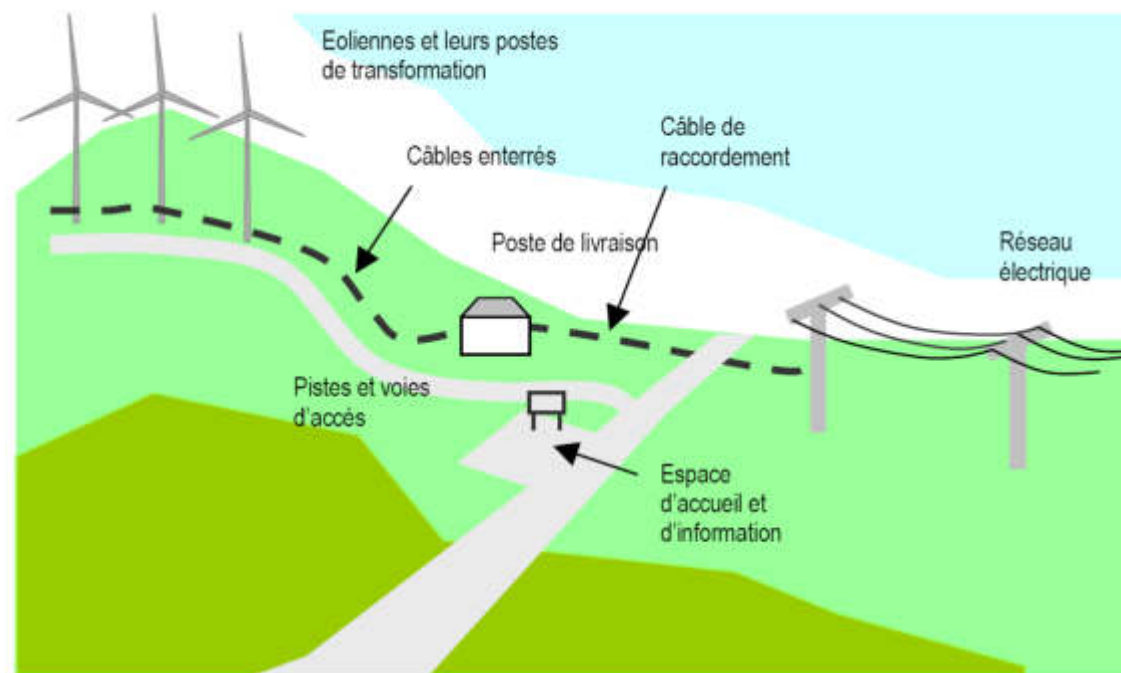
Figure 8 : Schéma descriptif d'un parc éolien
